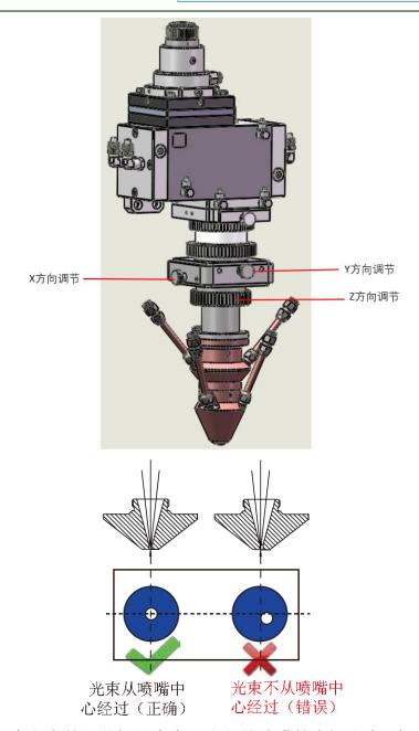
通过调试 X/Y 这两个方向的调节螺丝来实现光斑从喷嘴的中间出来,实现光斑与粉斑的重合。通过调节 Z 方向,可以实现焦距的调节。
