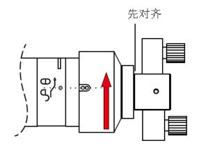
5. 再将转动套按图方向拉起;
