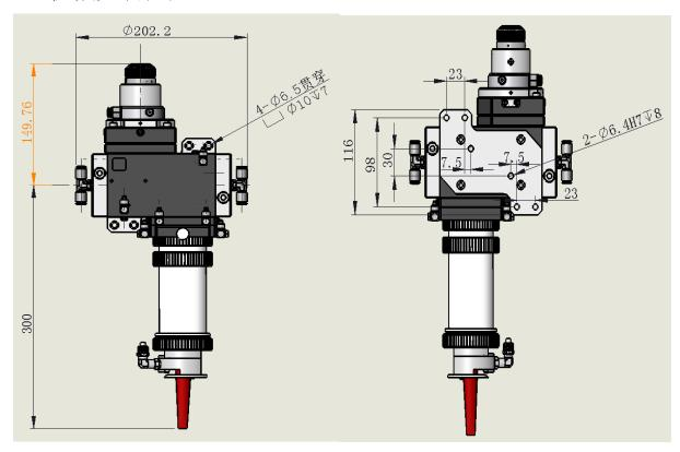
注:不同焦距配置,尺寸长度不一,此外标准配置尺寸。
